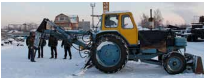
Установка гидромолота PB 70H на экскаватор ЮМЗ 1974 года выпуска.
