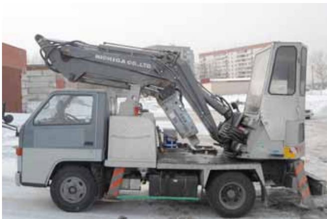
Установка гидромолота PB 70H на автомобиль Mitsubishi Canter 2001 года выпуска.
