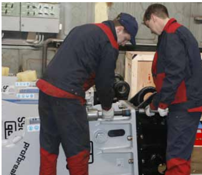
Установка сервисной бригадой переходной плиты на гидромолот.
